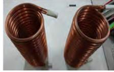
**水-冷媒熱交換器**
